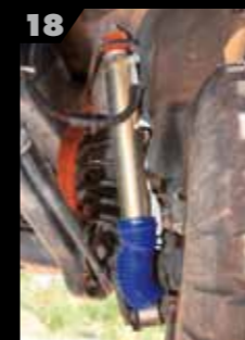
Los muelles realizados a medida para las suspensiones delantera y trasera (16 y 17) se complementaron con unas barras Panhard regulables en sus dos extremos (19) y amortiguadores Oram Step 3 de botella separada con regulación independiente elaborados también a medida (18).
