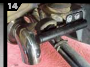
Para mejorar el rendimiento del motor de ocho cilindros (12) se reprogramó la centralita electrónica y, sobre todo, se montó una nueva línea de escape en acero inoxidable y sin el silencioso central (13, 14 y 15), con salida independiente para cada una de las dos bancadas de cilindros del propulsor.
