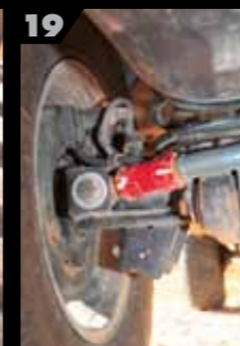
Los muelles realizados a medida para las suspensiones delantera y trasera (16 y 17) se complementaron con unas barras Panhard regulables en sus dos extremos (19) y amortiguadores Oram Step 3 de botella separada con regulación independiente elaborados también a medida (18).
