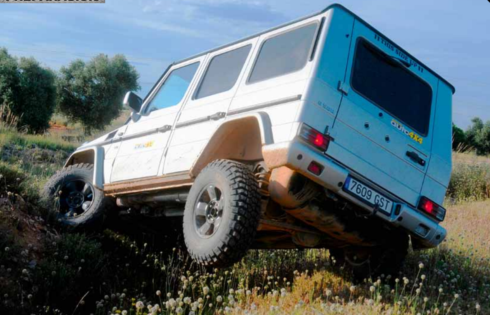
Las llantas Borbet en color negro no sólo aportan una estética distinta al vehículo, sino que, además, están diseñadas para conseguir un desplazamiento de 30 mm.
