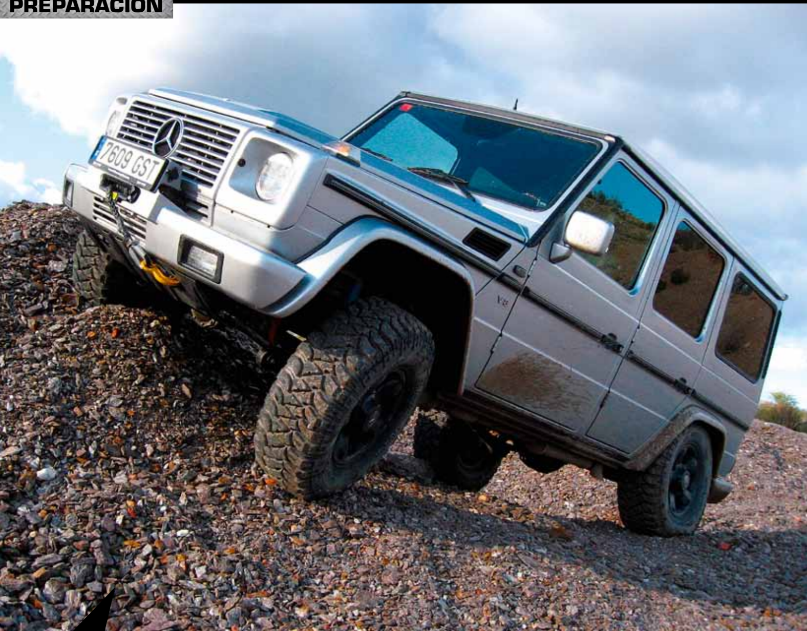
Los muelles más largos permiten ganar seis centímetros en los recorridos de suspensión, lo que mejora la capacidad trialera del G, ya de por sí notable en el modelo de serie.
