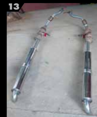
Para mejorar el rendimiento del motor de ocho cilindros (12) se reprogramó la centralita electrónica y, sobre todo, se montó una nueva línea de escape en acero inoxidable y sin el silencioso central (13, 14 y 15), con salida independiente para cada una de las dos bancadas de cilindros del propulsor.
