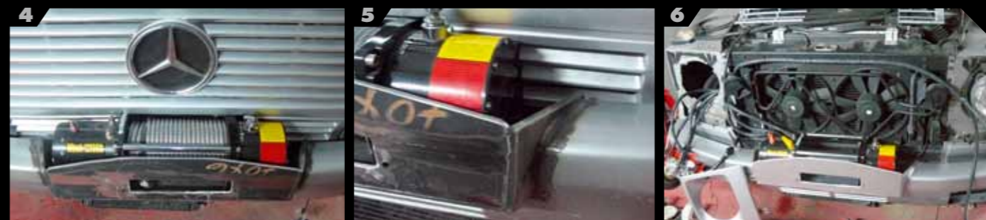
En esta secuencia observamos el proceso de montaje del cabestrante delantero, de hasta 5.400 kg, que exigió la modificación del parachoques delantero y la realización de un soporte de matrícula específico. La presencia del enorme radiador, con dos ventiladores, no dejaba mucho espacio para las conexiones eléctricas del cabestrante, dotado de cable de plasma. En la imagen de la derecha (9) vemos el cortacorrientes instalado.
