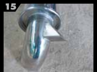
Para mejorar el rendimiento del motor de ocho cilindros (12) se reprogramó la centralita electrónica y, sobre todo, se montó una nueva línea de escape en acero inoxidable y sin el silencioso central (13, 14 y 15), con salida independiente para cada una de las dos bancadas de cilindros del propulsor.
