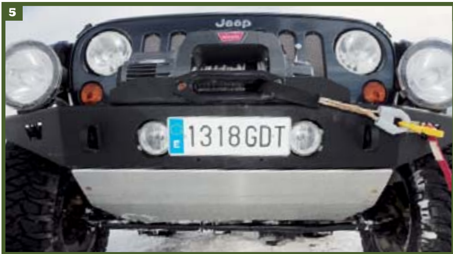
El paragolpes delantero (5), obra de Warn, incluye un cabrestante con cable de plasma y dos focos de largo alcance; el trasero, de la firma ARB (8). Los enormes pasos de rueda Bushrange (6) cubren las gomas Mickey Thompson. La zaga también integra rejillas de protección de los faros (7). El interior (9) conserva formas y mandos de serie, en espera de ulteriores modificaciones. Algo parecido ocurre con el motor (10), que mantiene sus especificaciones de fábrica.
